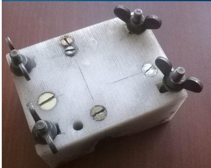
Подготовленная пресс-форма в закрытом положении
