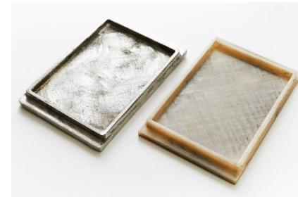
Пластиковая модель и отливка
