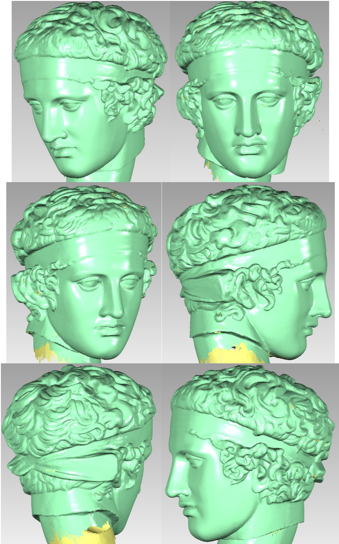
Трёхмерная модель численного масштаба 1:1 в виде облака точек высокой плотности; объем модели – 5.6 миллиона точек
