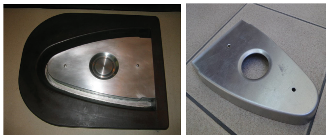
Рис. 19. Оснастка для формoобразования и отформованная деталь
