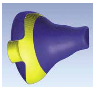
Рис. 13. Результаты моделирования процесса формовки со скольжением кромки по интегральной поверхности оснастки
